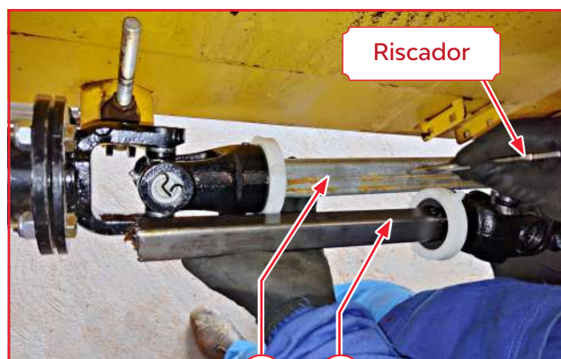
Verificação válida para os cardans (C1 e C4*) *Se aplicado
