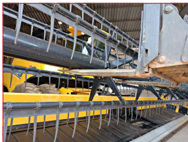
Apoio do molinete: usar recursos adequados para evitar o risco de sérios acidentes!
